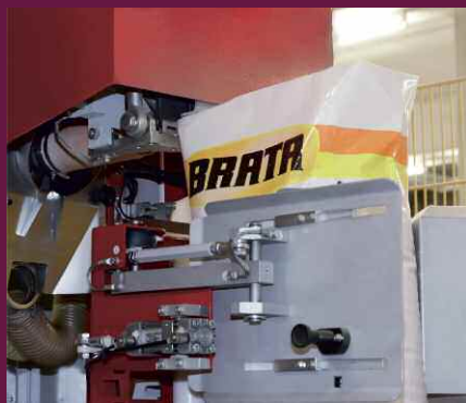
填充嘴处超声波直接封口
