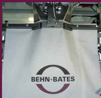
适用于粉料的防尘填充嘴 适用于灌装时会起尘的产品
