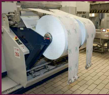
高效: 自动上卷减少更换膜卷时停机时间 Time-saving: Automatic reel changer for quicker film reel changes
