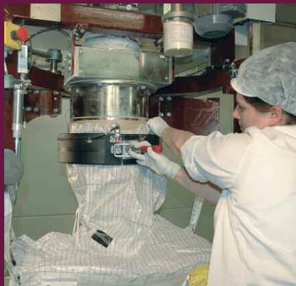
固定式出料嘴 - 配有膨胀胶管用于灌填充时防尘
