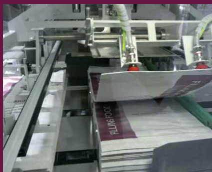
安全：袋子底部进行空袋分离实现无故障运行。
